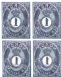
Klisjeen med fire frimerker støpes i den høyden trykkesmaskinen krever. Det støpes 25 klisjeer x 4, som danner trykkformen med 100 frimerker.
